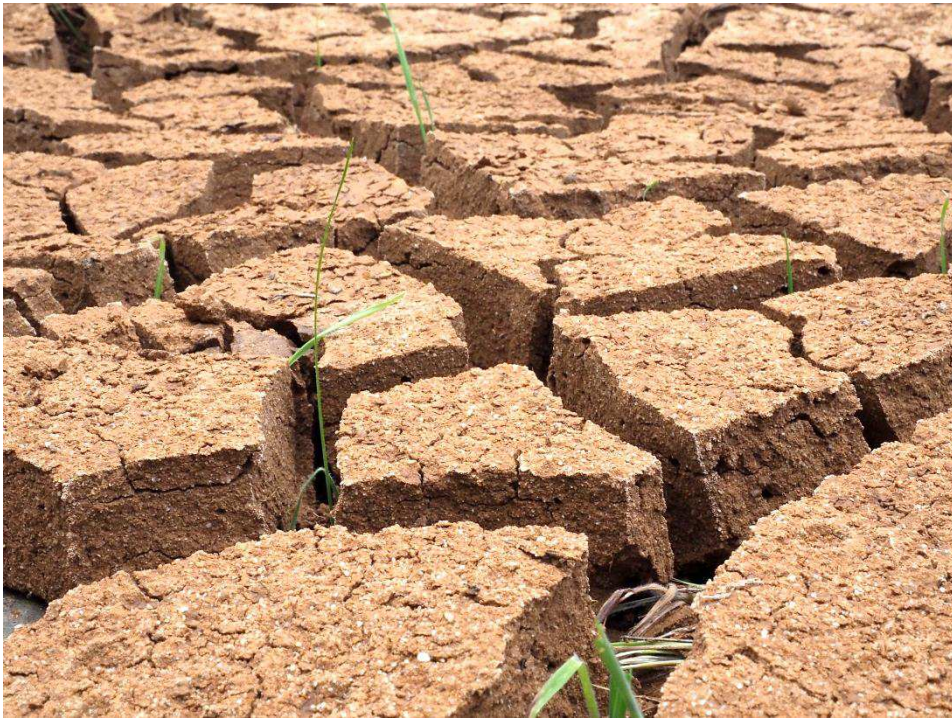
Schrumpfungsrisse am Standort A 39
